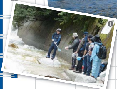
防水胴長をはいて河床を調査したり②、水質分析用に河川水①や湧水③を採取します。
